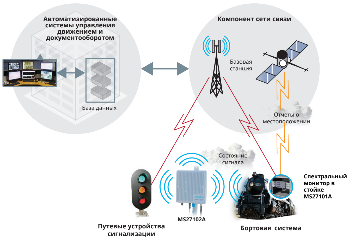
Рис. 1. Использование MS27101A в системе принудительного управления поездом
